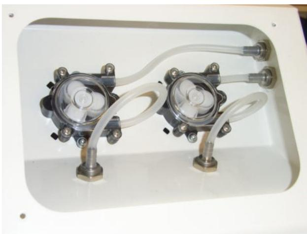
Um den Dosierschlauch zu tauschen muß der Dosierpumpenkopf geöffnet werden. Dazu die 4 Kreuzschlitzschrauben an den Befestigungsösen vom Klarsichtdeckel herausdrehen und den Klarsichtdeckel abnehmen.
