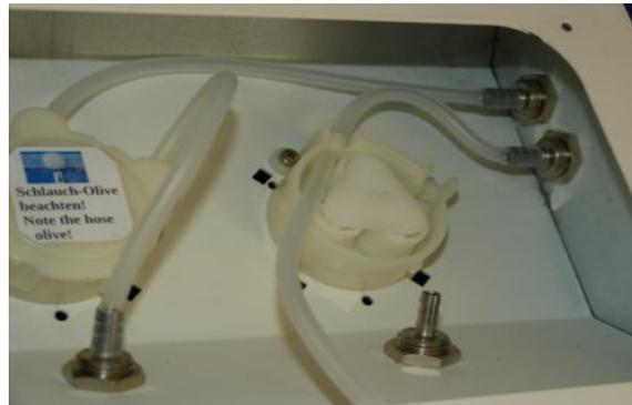
Den Schlauch im weiteren Verlauf in den Pumpenkopf einlegen, dabei die Rollen im Gegen-Uhrzeiger-Sinn drehen und den Schlauch ins Gehäuse führen.
