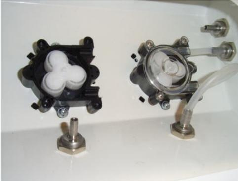
Den alten Schlauch von dem Metall-Schlauchstutzen abziehen und aus dem Dosierkopf entnehmen.
