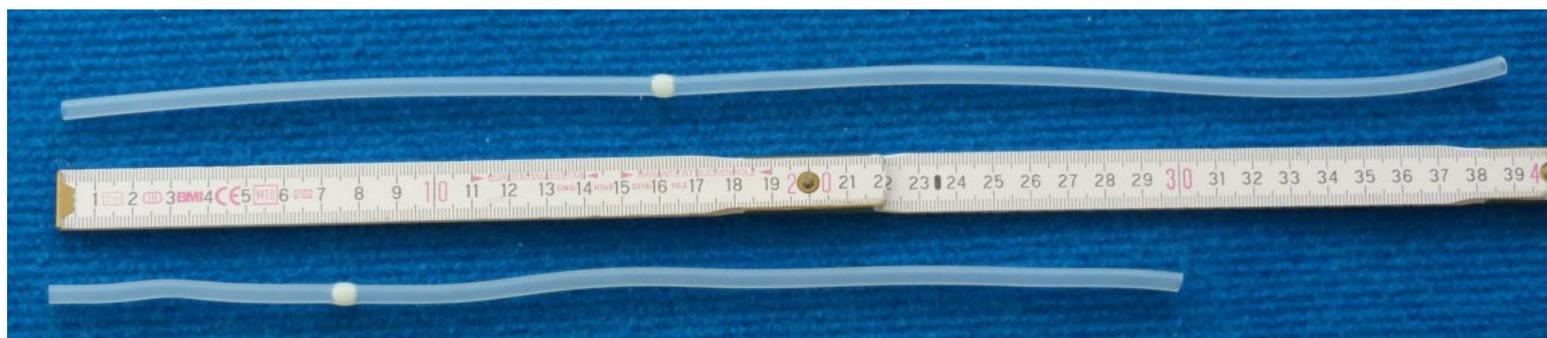
Den neuen Schlauch mit eingesetzter Schlauch-Olive wie abgebildet auf den Metallstutzen aufstecken und in die Dosierpumpe einsetzen.
