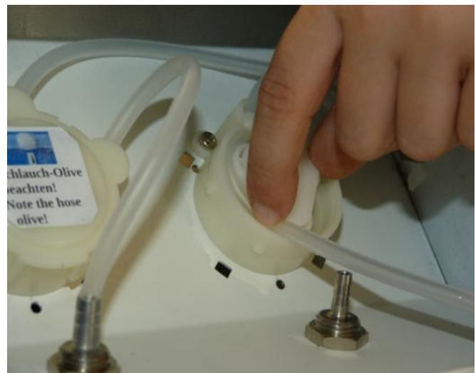
Pumpendeckel aufclipsen und den Schlauch in einem gleichmäßigen Bogen auf den unteren Metallstutzen aufstecken.
